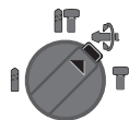
Läge Vario-Lock för inställning av mejselläget I detta läge snäpper inte slag-/vridstoppssomkopplaren 11 fast.
